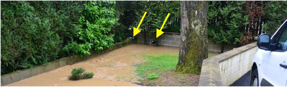
*Photo 5 : ouvertures dans mur au n°5 chemin de la Corneille (22 mai 2016) pour permettre l'évacuation des écoulements*
